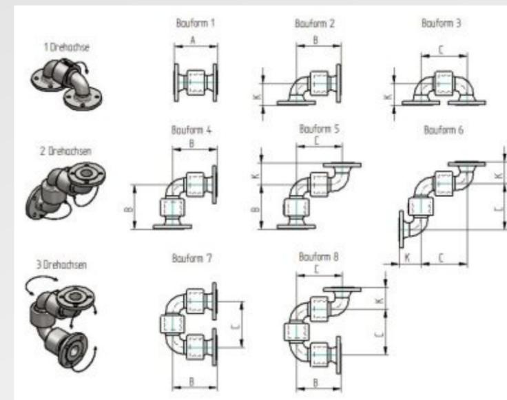
ATN Rohrdrehgelenke werden mit axial wirkenden Nutringen aus PTFE (Teflon) abgedichtet. Spezielle Ausführungen wie z.B. Lebensmittelanwendungen (FDA) sind wie auch Abstreifersysteme für abrasive Medien jederzeit möglich. Nach außen hin sind ATN Rohrdrehgelenke mit O-Ringen oder Dichtelementen ausgestattet und lassen einen Einsatz in und außerhalb des Mediums zu.
